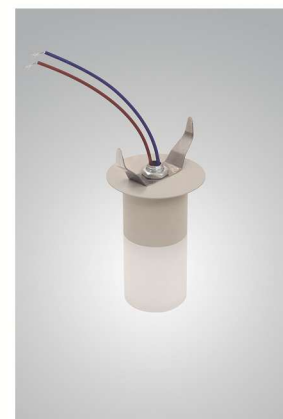
Plafon 1243 Porta lâmpada: 1 x G9 Halopin Difusor: Acrílico fosco Luminária: Ø 55 x 112 mm Base de teto Full Contact c/ Mola: Ø 55
