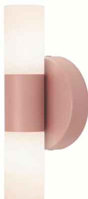
Arandela 4162 Porta lâmpada: 2 x G9 Halopin Difusor: Acrílico fosco Luminária: 185 x 90 x 60 mm Base de parede: Ø 90 x 20 mm
