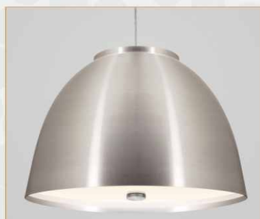
PENDENTE KALIL PLUS 2037 Porta lâmpada: 1 x E27 Luminária: Ø 450 x 280 mm Difusor: Acrílico branco Base de teto: Ø 120 x 15 mm Cabo de alimentação: ⇄ 2 m (regulável)
