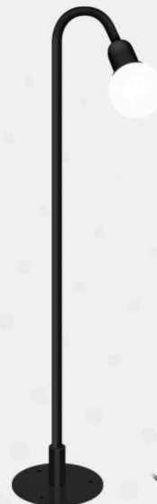
BALIZADOR SPHERA GLOBE 1373 Com base Porta lâmpada: 1 x G9 Halopin Difusor: Globo de vidro branco opalino com rosca Ø 100 mm Luminária total: Ø 200 x \Phi 800 mm Base: Ø 107 x 3 mm
